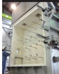
小型炉防火試験装置
